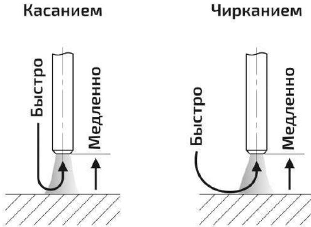
Рис. 8.0.1. Способы зажигания сварочной дуги.
