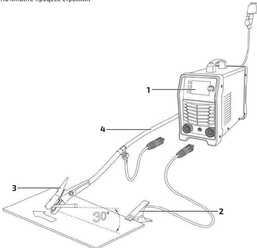
Рис. 11.0.1. Схема подключения электрододержателя для строжки.
