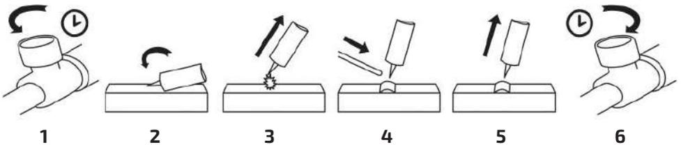
Рис. 10.7.2. Способ поджига дуги от сопла горелки.
