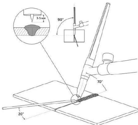
Рис. 10.9.1. Стыковое соединение.
