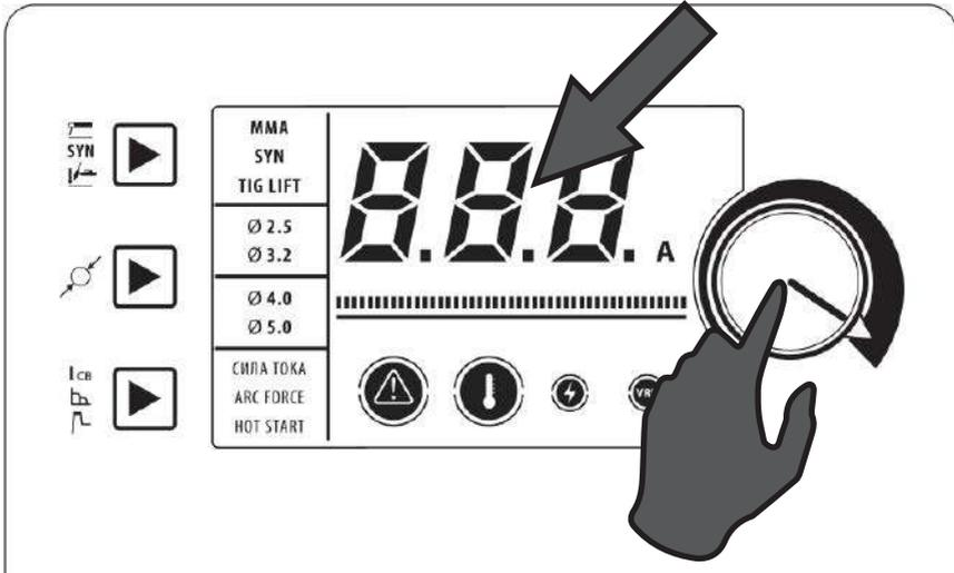
Рис. 11.0.2. Установка сварочного тока для строжки.
