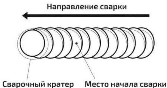
Рис. 8.1.2. Начало сварки при смене электрода.
