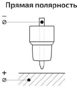
Рис. 10.1.1. Полярность при TIG сварке.
