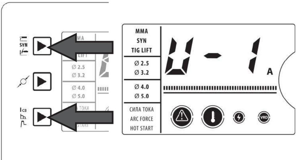
Рис. 6.2.4. Включение функции VRD.
