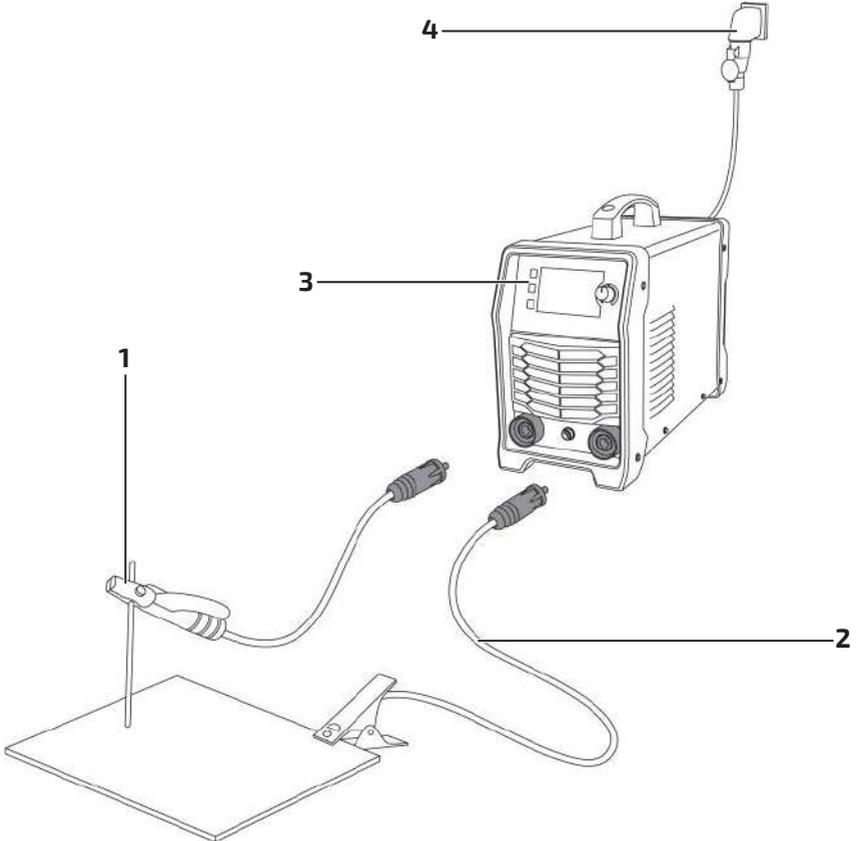
Рис. 7.0.1. Схема подключения оборудования.
