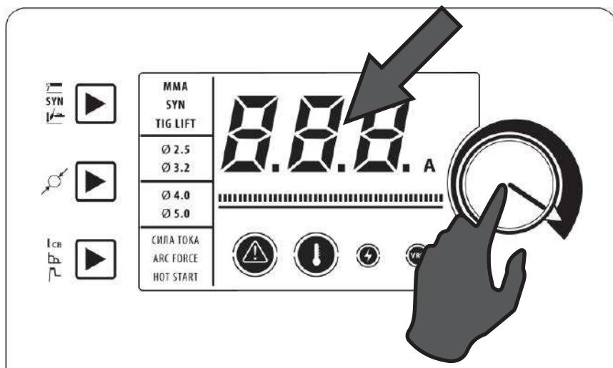
Рис. 11.0.2. Установка сварочного тока для строжки.
