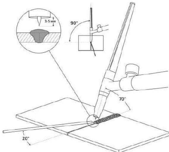
Рис. 10.9.1. Стыковое соединение.
