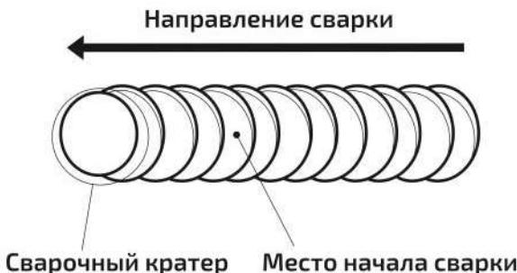
Рис. 8.1.2. Начало сварки при смене электрода.
