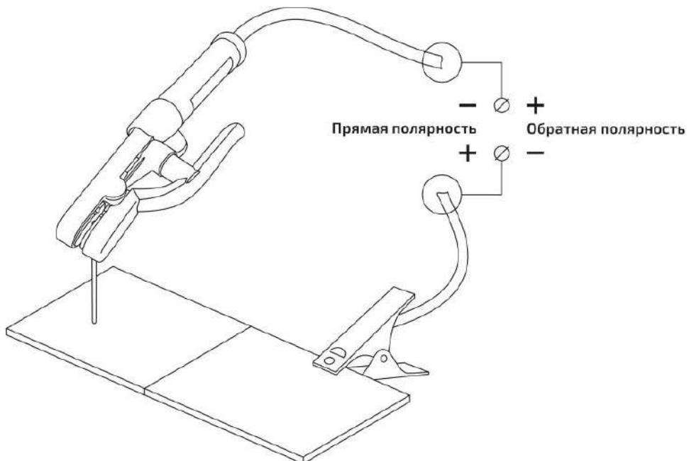
Рис. 8.2.1. Способы подключения.
