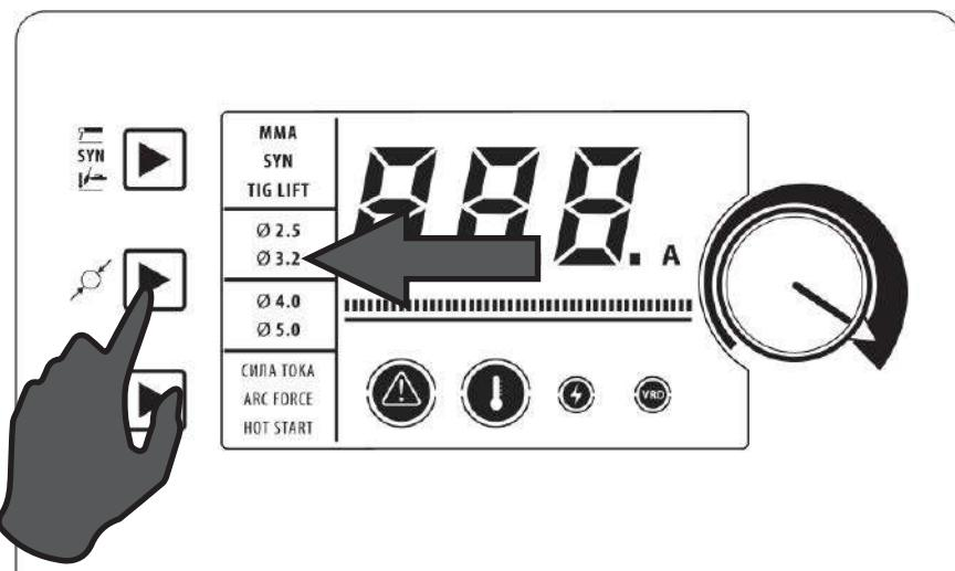
Рис. 7.3.2. Выбор диаметра сварочного электрода.
