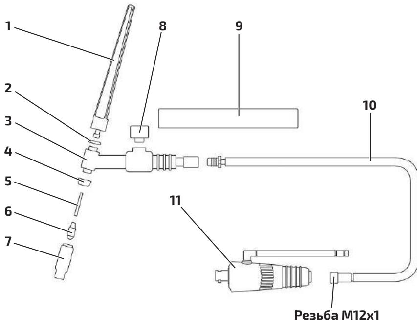
Рис. 10.2.1. Схема вентильной горелки для аргонодуговой сварки.
