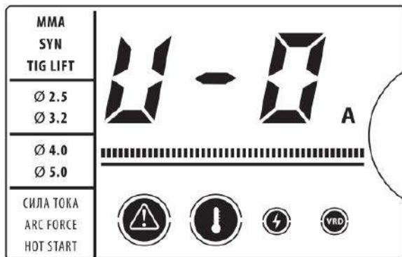
Рис. 6.2.5. Выключение функции VRD.
