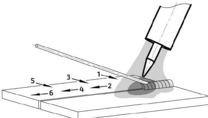
Рис. 10.8.2. Пример манипуляции присадочной проволокой при TIG сварке.
