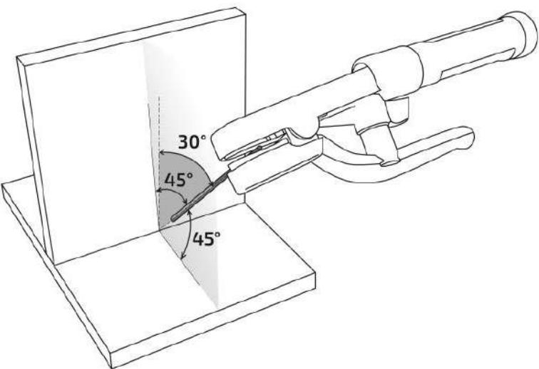
Рис. 8.1.3. Угол наклона электрода.
