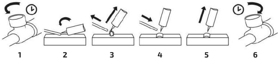
Рис. 10.7.3. Способ поджига дуги от присадочного прутка.
