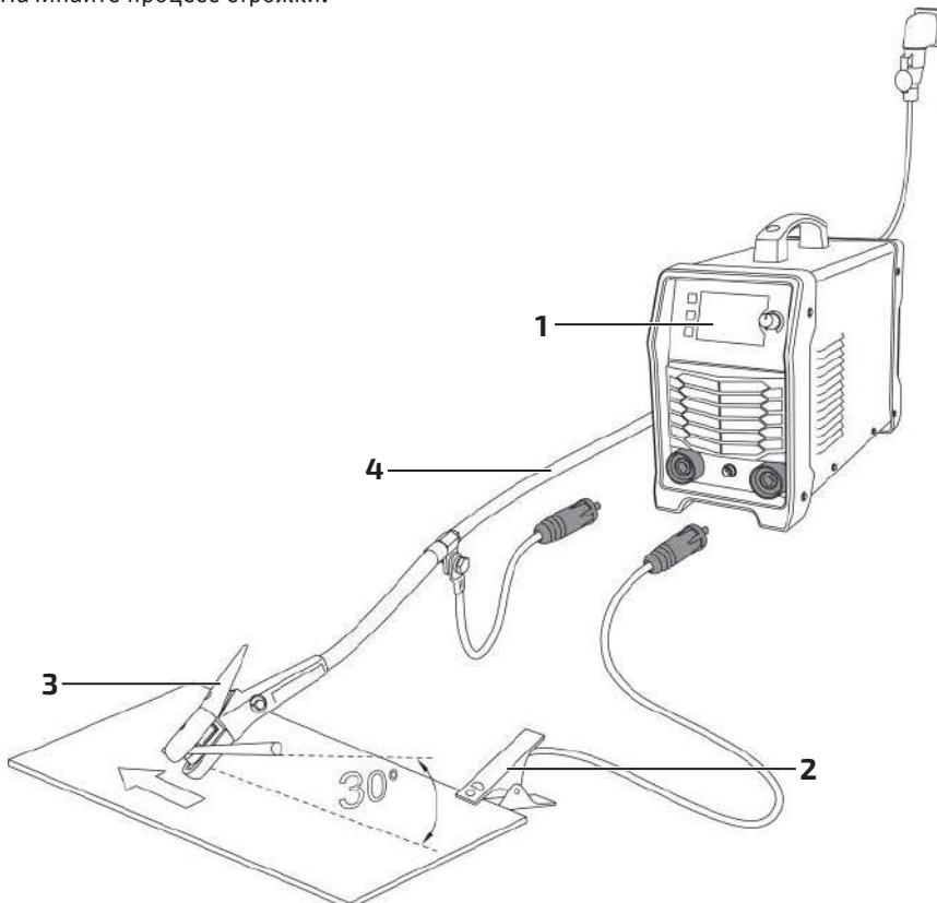
Рис. 11.0.1. Схема подключения электрододержателя для строжки.
