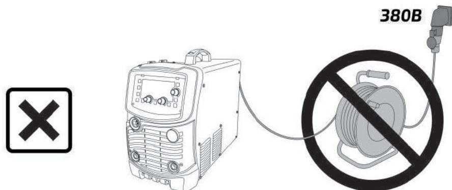
Рис. 6.3.3. Схема неправильного подключения и удлинения кабелей аппарата.
