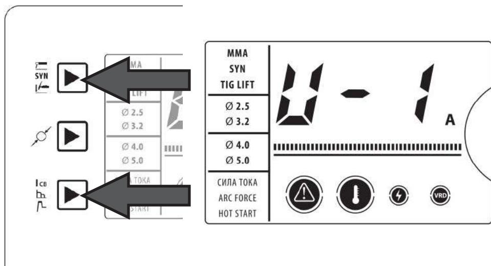
Рис. 6.2.4. Включение функции VRD.
