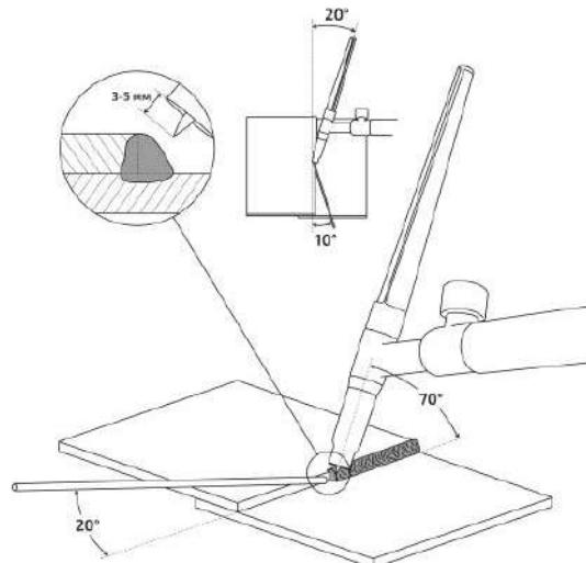
Рис. 10.9.2. Нахлесточное соединение.
