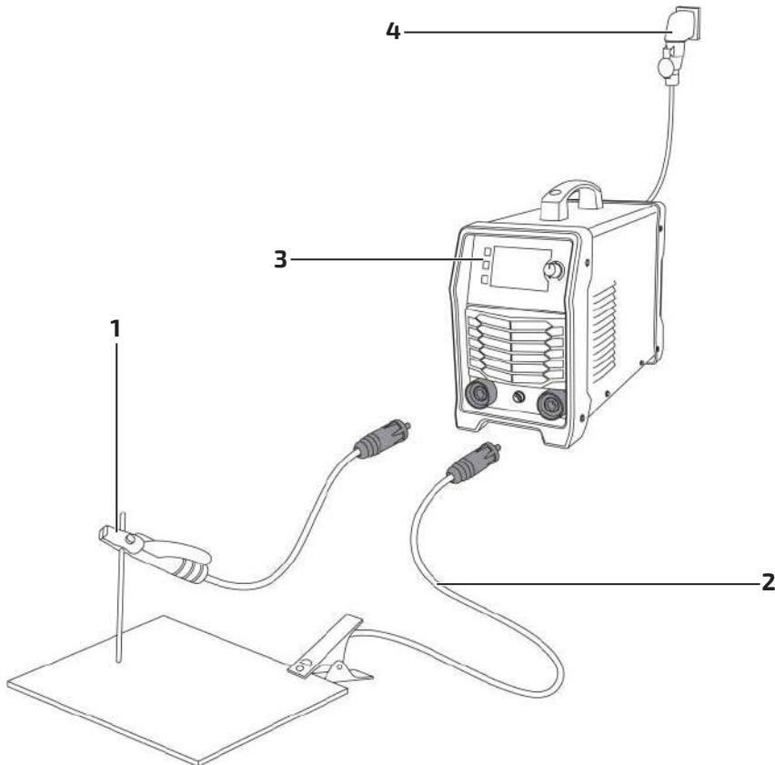
Рис. 7.0.1. Схема подключения оборудования.
