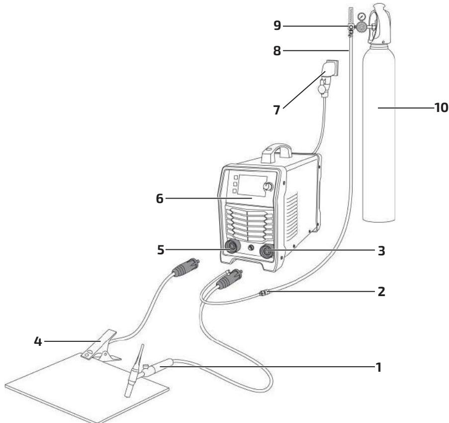
Рис. 9.0.1. Схема подключения вентильной горелки.
