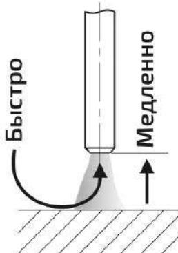
Рис. 8.0.1. Способы зажигания сварочной дуги.
