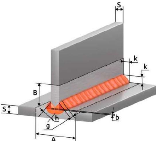
Рис. 13.0.2. Пример таврового соединения.
