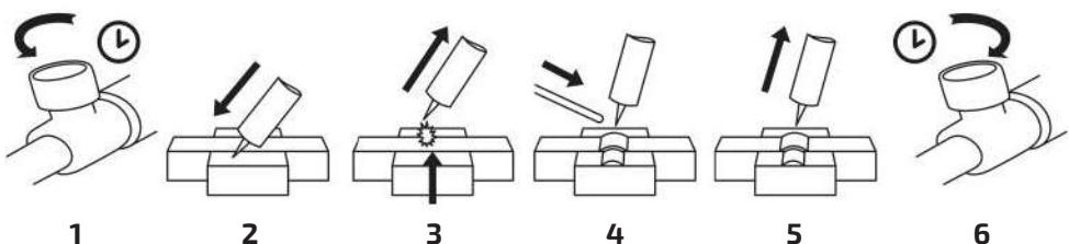
Рис. 10.7.4. Способ поджига дуги на выводной пластине.
