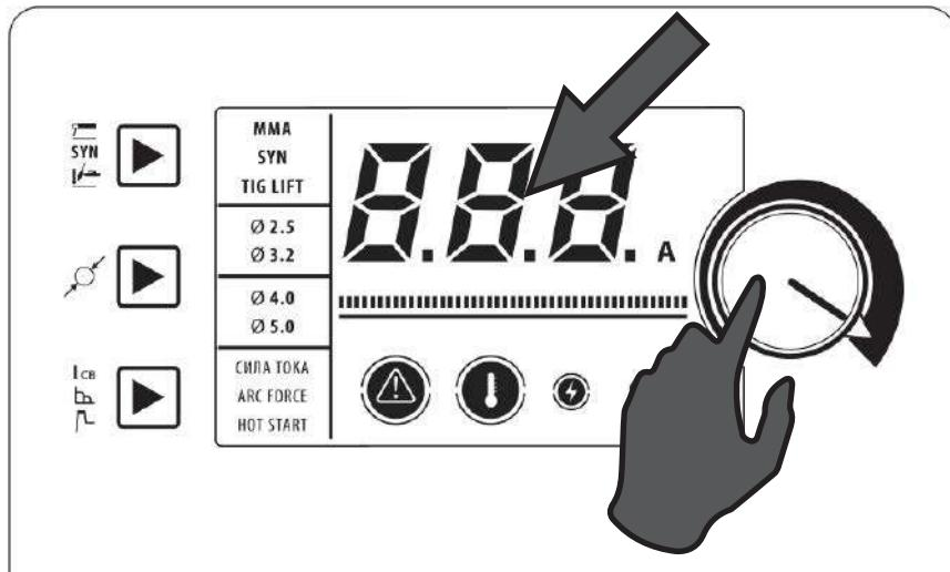
Рис. 9.1.2. Установка силы тока.
